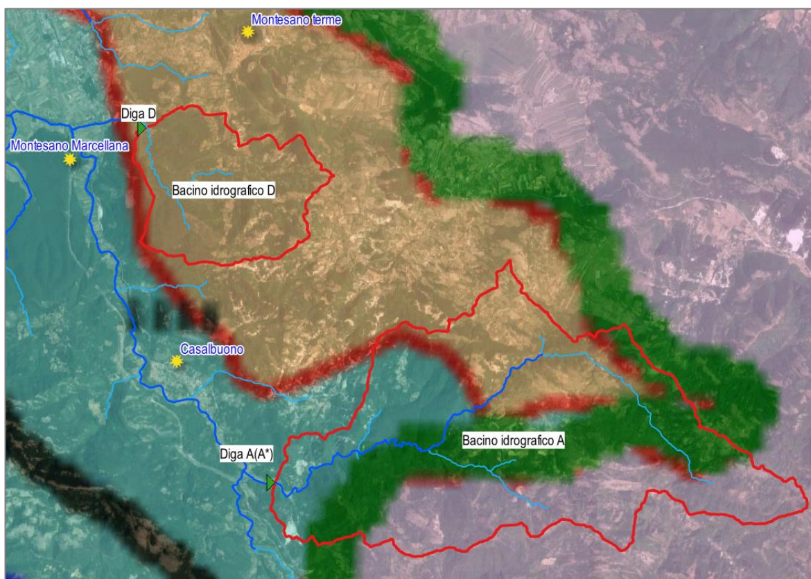
Figura 52: Dettaglio della sovrapposizione tra le Area Pluviometrica Omogenee definite dal VAPI Campania ed i bacini idrografici considerati. In arancione l'area A3 ed in turchese l'area A4
